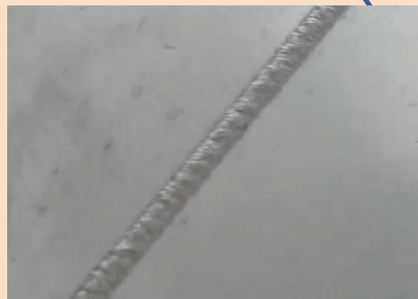
アルミ突合せ溶接(フィラ有) ビード外観
